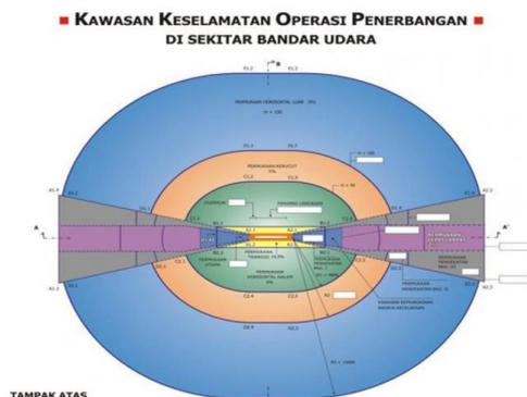
Gambar 1. Batas-batas Kawasan Keselamatan Operasi Penerbangan
